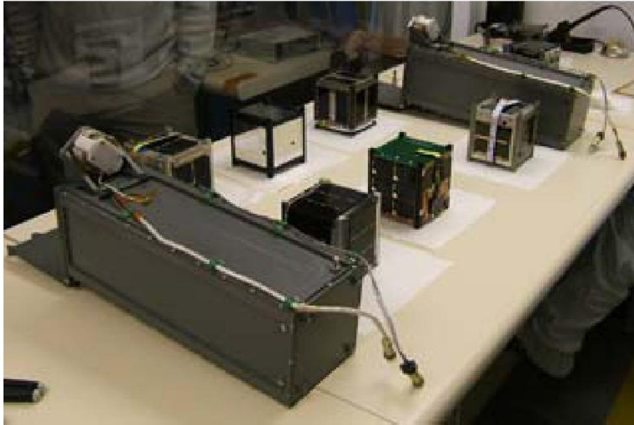
Figura 2.3: Vista de seis cubesats y dos despleadores
