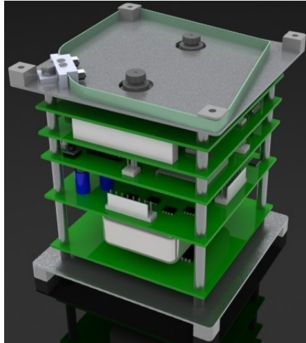
Figura 6.1: Interior del CHASQUI I, se observan la disposición de las tarjetas de los distintos módulos
