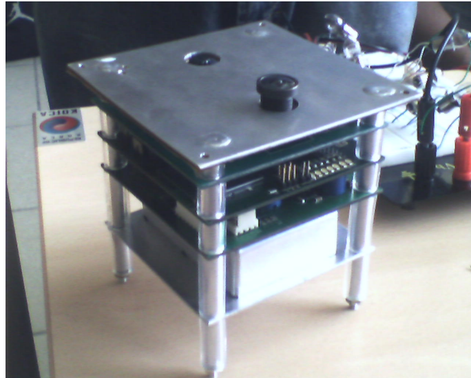
Figura 6.5: Estructura Manufacturada y sub ensamblada con las tarjetas
