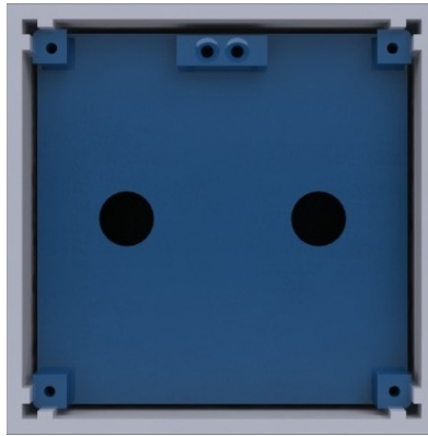
Figura 5.13: Ocho superficies rectangulares de contacto entre el CHASQUI I, el resorte del P-POD y otro cubesat en dirección normal a la tapa de cámaras, dos superficies rectangulares por cada cara lateral del CHASQUI I en contacto con los rieles del P-POD
