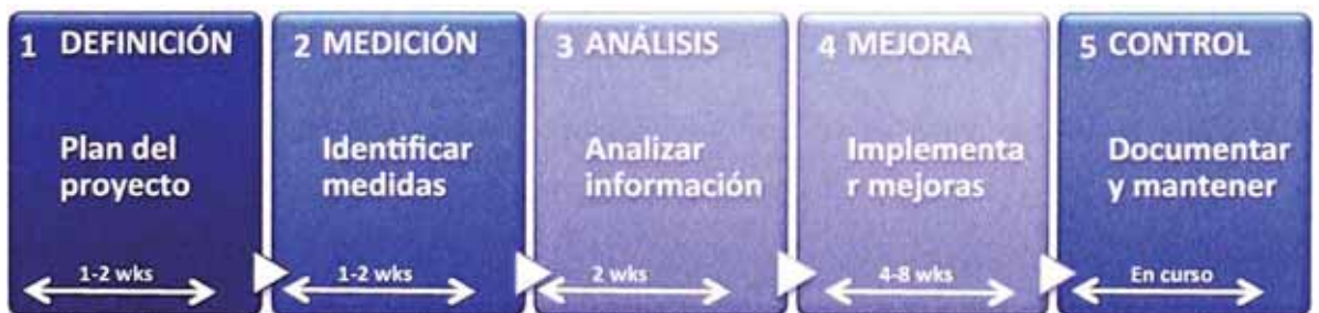
Figura 11: Fases de un proyecto Six Sigma (DMAIC)
