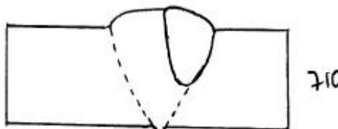
FIGURA 7.14 : REPARACIÓN DE LA ZONA DE RELLENO
