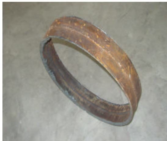
FIGURA 7.17 : CORTE DE UNA JUNTA RECHAZADA
