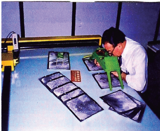
Figura N° 8.- Localización y orientación de puntos geodésicos en fotografías aéreas sucesivas
