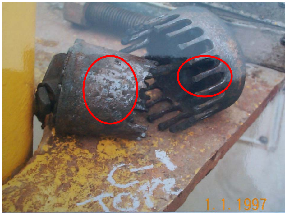
Figura 4: Base del casquete atacado por corrosión bajo depósitos.
