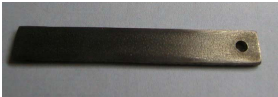
Figura 47: Cupón de corrosión
