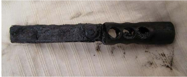
Figura 33: Cupón de corrosión instalado en el sistema de tope de una unidad de destilación primaria de base seca, sin agua de lavado.
