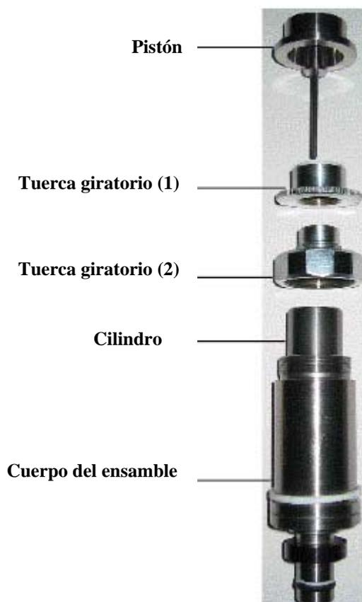
**Figura 3.4.** Ensamble pistón-cilindro tipo simple
