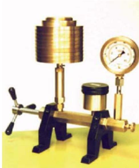
**Fig. 31.- Balanza de presión TGB BPM 700K**
