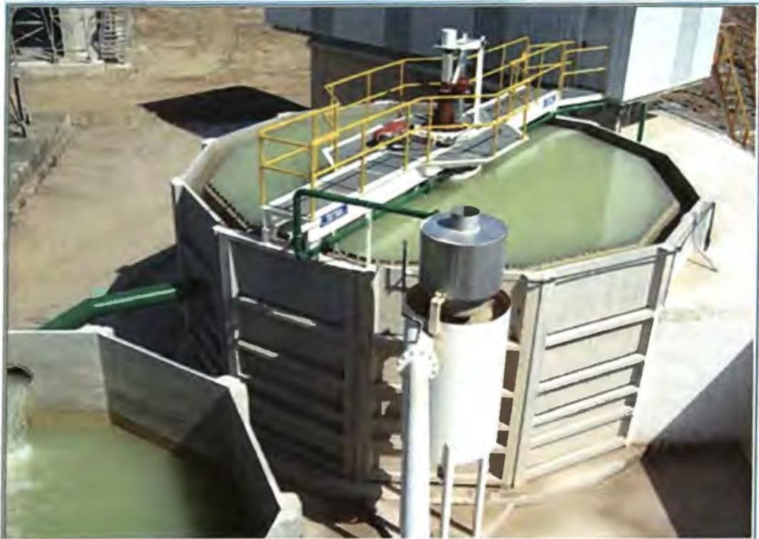
Figura 3.3 Fotografía de un espesador.
