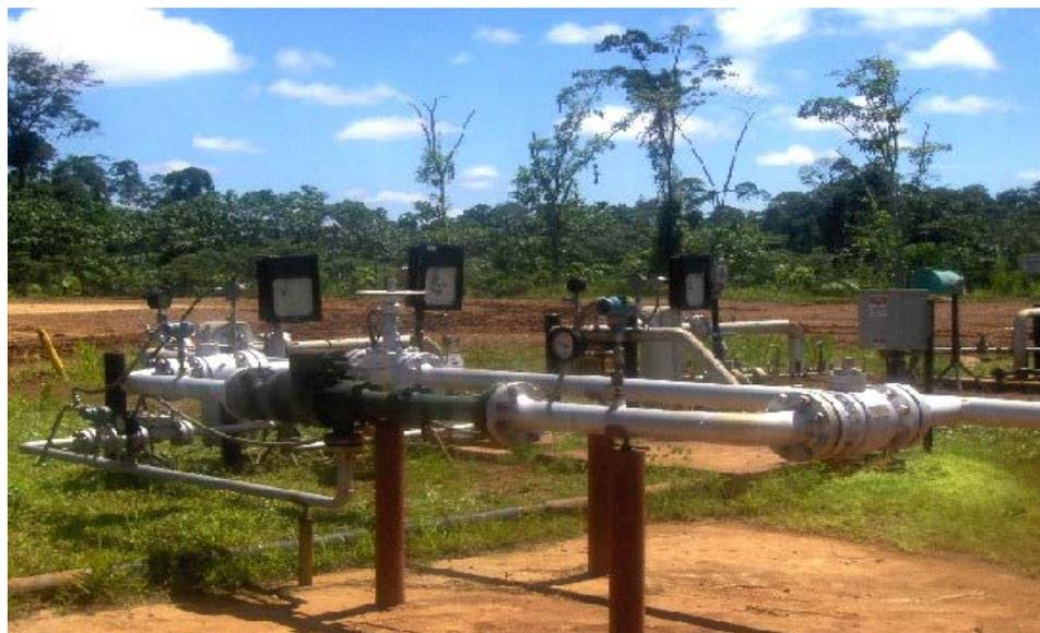
Fotografía del equipo eductor instalado en Pozo SHIV 1603.
