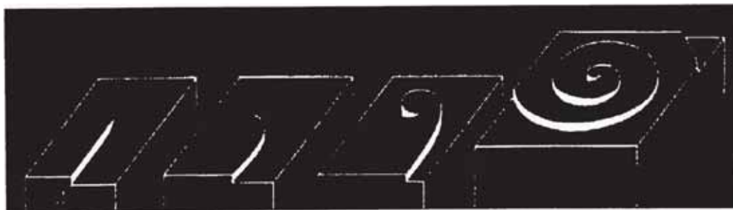
Figura 28: Proceso de elevación de un crecimiento microespiral partiendo de un plano
