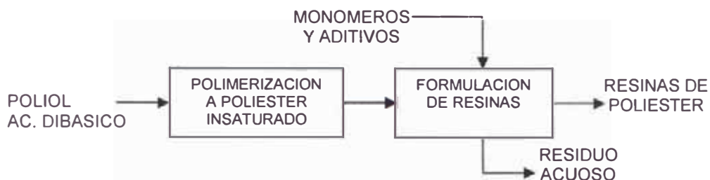
Figura 53 Esquema de producción de resinas alquídica modificada o poliéster.
