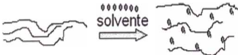
Figura 26 Formación de película de un polímero termoplástico.
