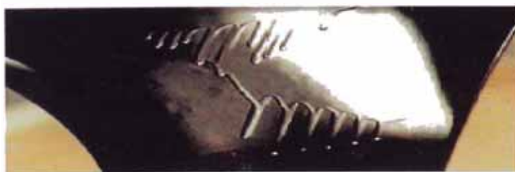
Figura 11 Descolgamiento de un recubrimiento por uso inadecuado de solventes
