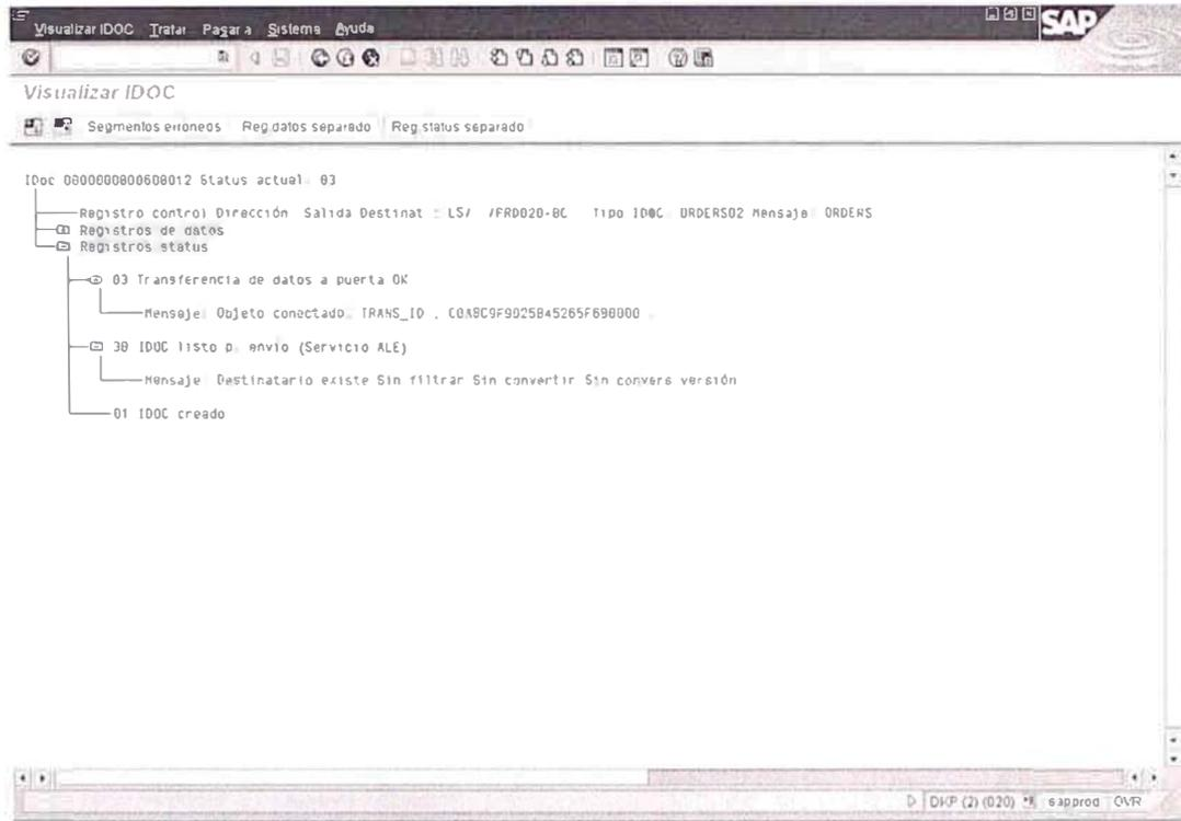
Esta es la estructura del documento de salida del servidor ERP, que consta de registros de datos y de estado.
