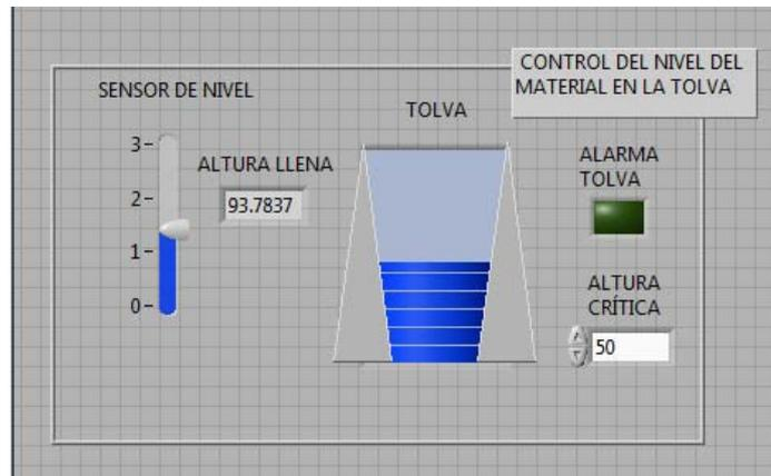
Figura 3.32 Módulo de interacción con la tolva
