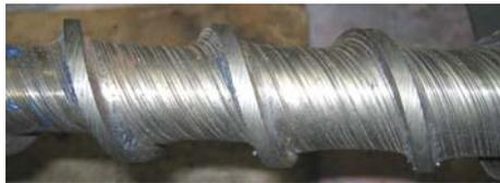
Figura 3.52 Desgaste del tornillo por temperatura baja del material a extruir
