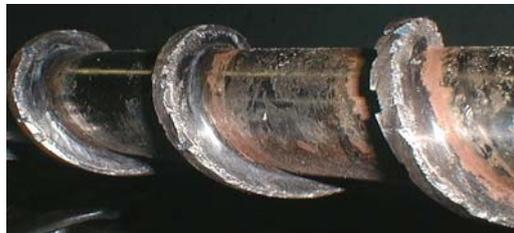
Figura 3.54 Desgaste del tornillo por desmoronamiento.
