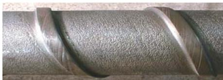
Figura 3.53 Desgaste por acción corrosiva de químicos en la superficie.
