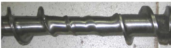
Fotograma 3.1 Desgaste del tornillo producido por materiales abrasivos.
