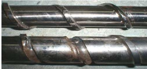
Figura 3.51 Desgaste del tronillo en forma cóncava
