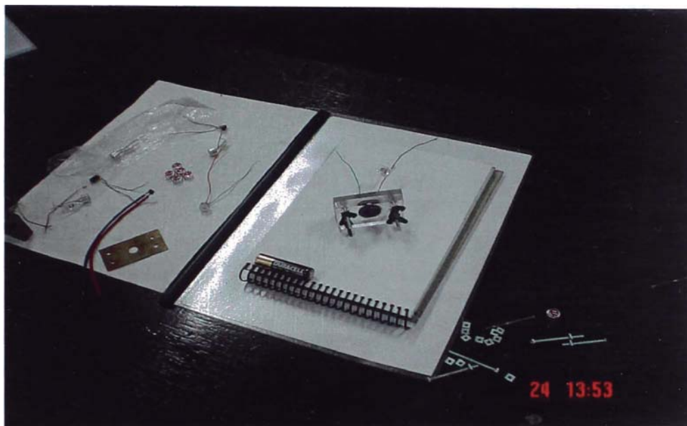
Figura 9.- La fotografía de la celda fotoacústica (derecha) indica en forma relativa las dimensiones y características empleadas en su fabricación. Al lado izquierdo se aprecian los detectores (micrófonos) utilizados.
