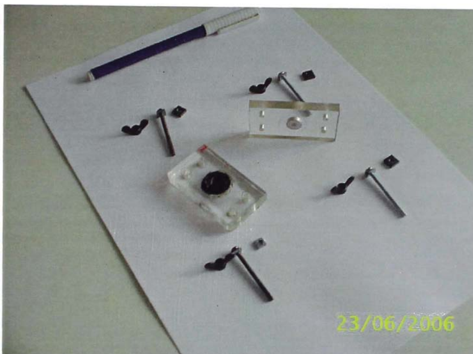
Figura 11.- Fotografía de la celda fotoacústica mostrando la colocación del plástico negro encima del disco de jebe. También se aprecian los 4 tornillos necesarios para el buen sellado de la cámara de gas.
