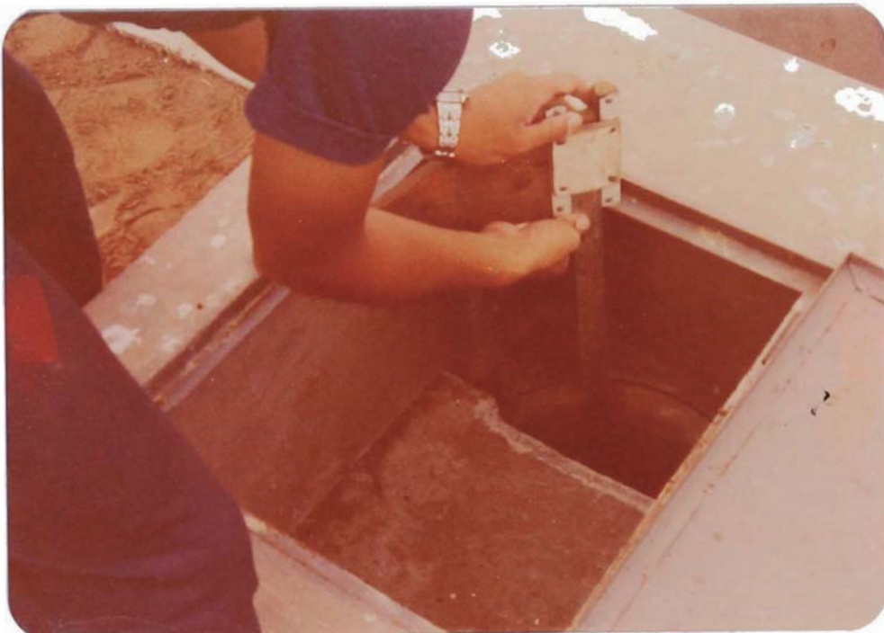
Fig. No. 41-d Medición de la carga hidráulica .
