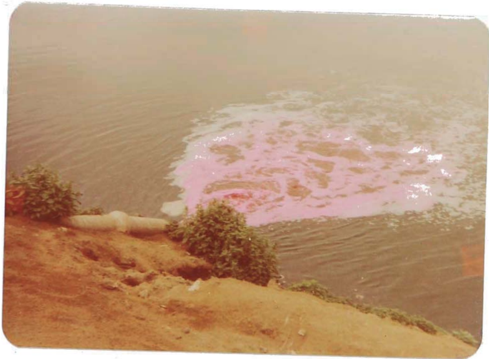
Fig. No. 49 VISTA EN PLANTA DE DISTRIBUCION DE VELOCIDADES DE FLUJO Y DIFUSION TURBULENTO (Flujo de Pistón disperso) .
