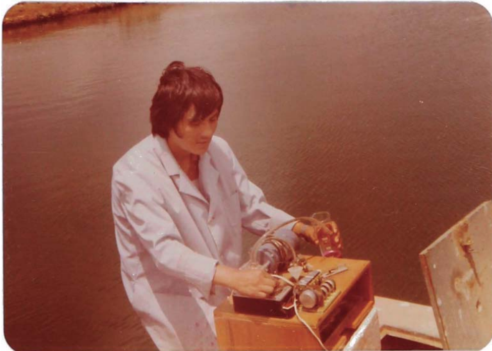
Fig. No. 41-a Calibración de la bomba PERISTALICA .
