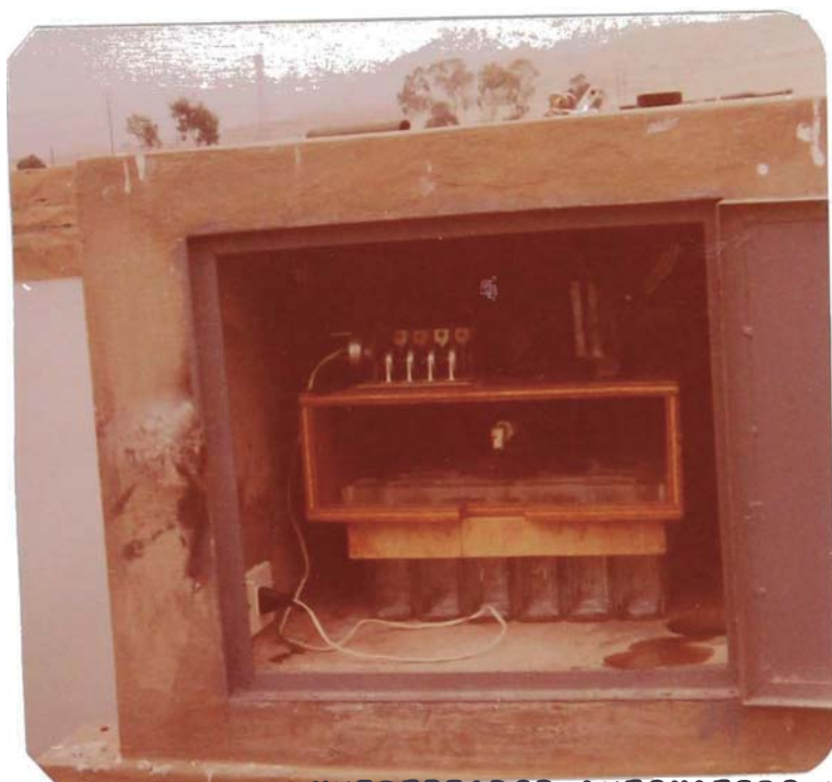
Fig. No. 50 MUESTRADOR AUTOMATICO USADO EN LOS EFLUENTES DE LAS LAGUNAS DE SAN JUAN.
