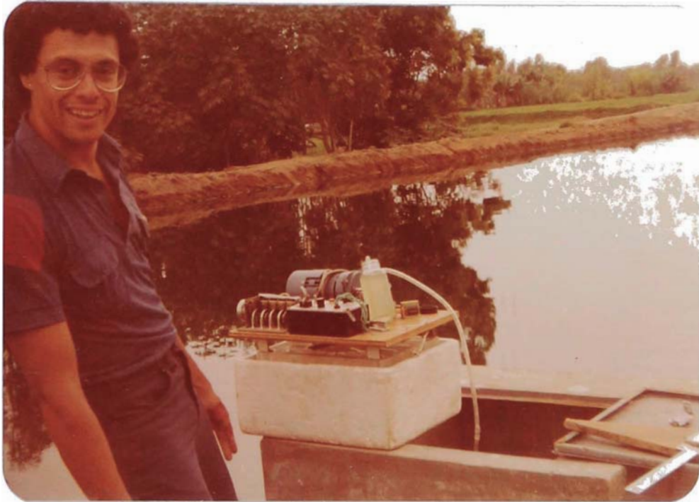
Fig. No. 41-f Bomba PERISTALICA usado en las Lagunas de San Juan para la dosificación continua de la diluida de Rhodamina.
