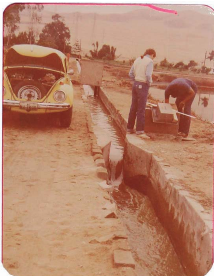
Fig. No. 11 MEDIDOR PARSHALL QUE MUESTRA POZO LATERAL DE MEDICION - CASETA PAR A LIMNIGRAFO.
