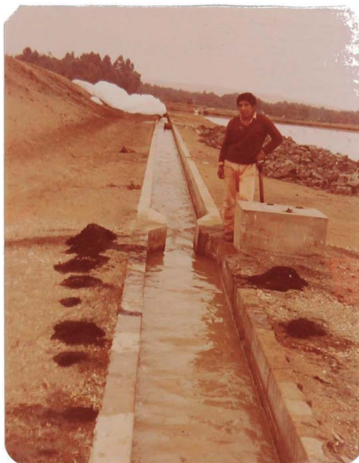
Fig. No. 13 MEDIDOR PALMER - BOWLUS CON SU CASETA PARA LIMNIGRAFO. USADO EN LAGUNAS DE SAN JUAN.
