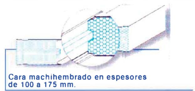
**Fig. 5.4 Paneles junta machihembrada.** Los paneles sin perfil, presentan ensamble machihembrado en la superficie metálica y de acuerdo al espesor, tres modalidades de contacto para el núcleo de poliestireno expandido.
