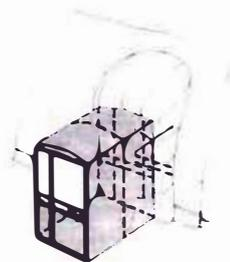
**Fig. 6.29 Salida de Emergencia**, en aluminio jacoado blanco, con mirillas en plexiglás. No hay túnel y su apertura hacia el exterior es facilitado por muelle antipánico.
