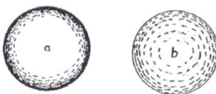
Fig. I.8: Secciones transversales de fibra mostrando tinturas anulares; a. Poco penetrada, b. Muy penetrada
