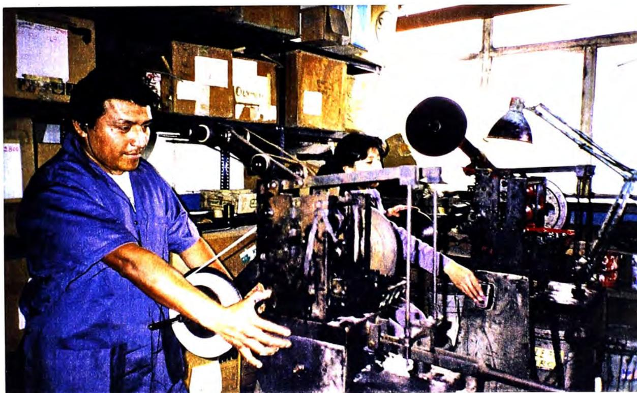
**MEDICION** : En este proceso se solicita del almacén de productos en proceso el tipo de cinta ya entintada, siendo colocada en la medidora se procede a medirla, considerando las especificaciones (cantidad y longitud) de la orden de pedido.
