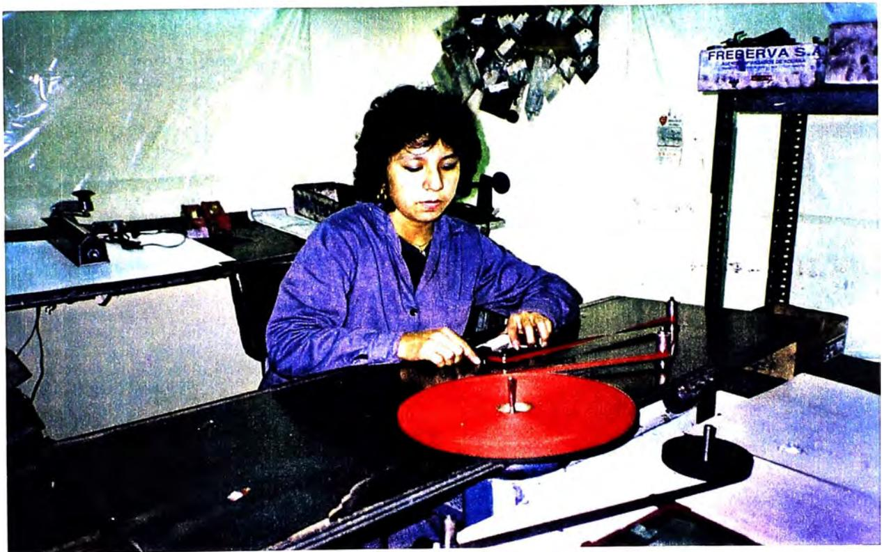
**SELLADO** : Una vez que el contenedor es llenado, el proceso siguiente es realizar el sellado : unión de los extremos que quedan fuera del contenedor; para formar así un sin fin a través de el . Este proceso se realiza empleando una maquina selladora la cual tiene que haber sido
