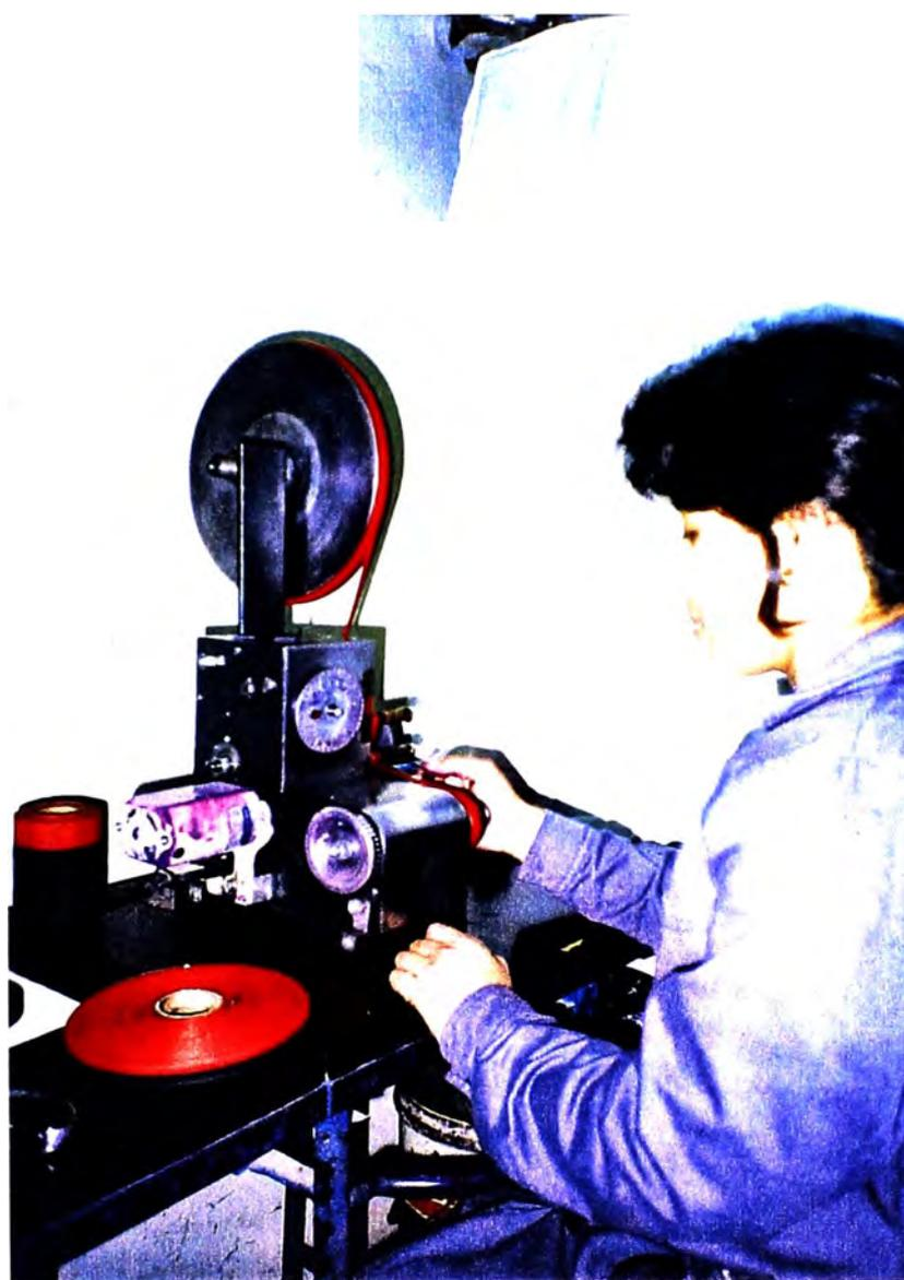
**ENCASSETADO** : En este proceso la cinta entintada ya medida es encasitada en cualquiera de las máquinas encasitadoras, este proceso se realiza a alta velocidad introduciendo la cinta en cartuchos (contenedores) que se suministran previamente armados. Tanto la cinta como los contenedores son proveídos por el almacén de materiales de acuerdo a la orden de pedido recibida.
