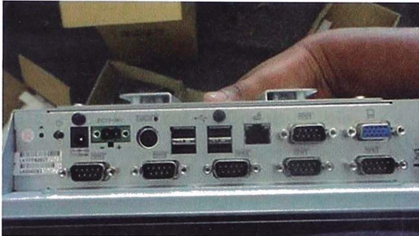
Ilustración 3.21: Panel PC utilizado para el almacenamiento y transmisión de la información
