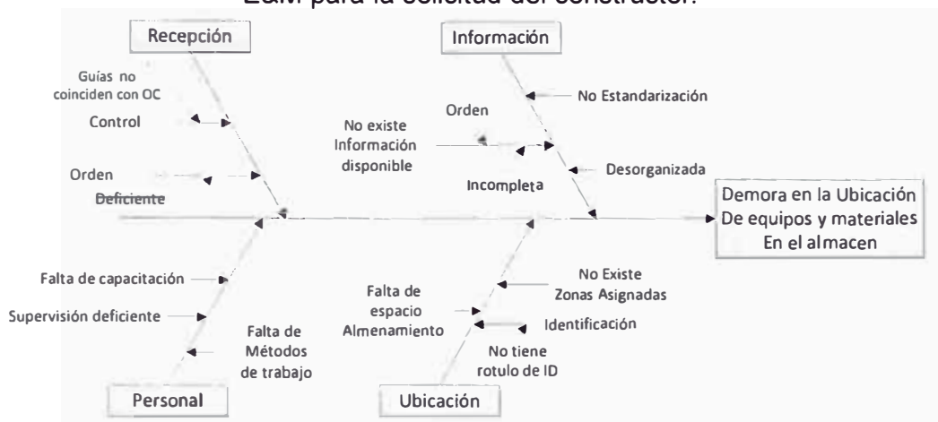
GRÁFICO N°19 – Diagrama de causa y efecto demora en ubicación de E&M para la solicitud del constructor.
