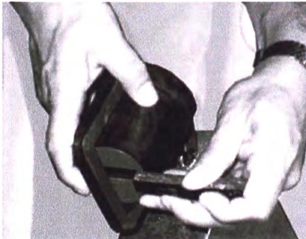
Luego colocar el crisol en el soporte de la retorta, cerrar herméticamente, colocar en la base del crisol la cuña. La misma que inicialmente se debe ir apretando poco a poco.
