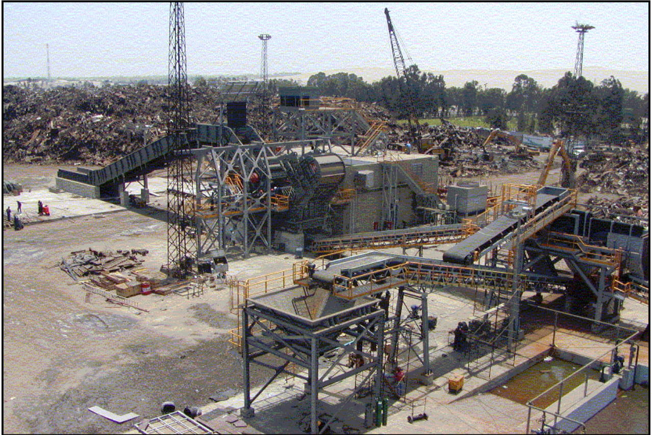
Fig.4.- Máquina Fragmentadora, marca Harris, martillos de acero al manganeso. Producción 1000 toneladas/día.
