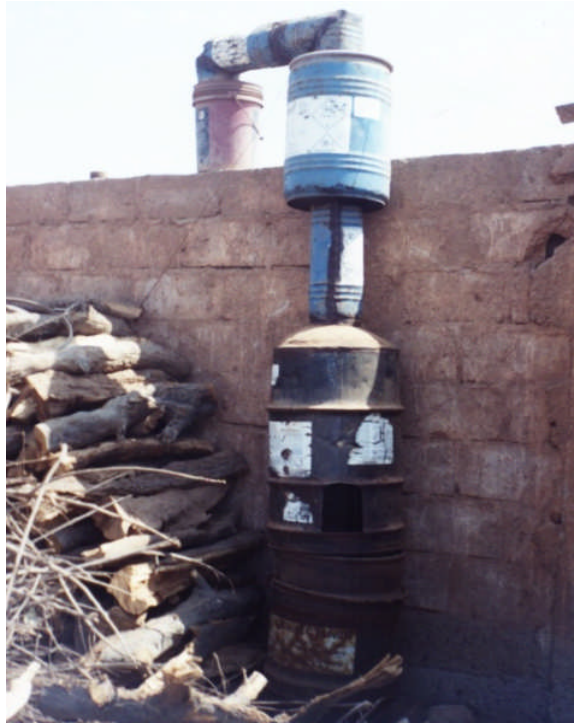
FOTOGRAFIA N° A4: Retorta Artesanal para la quema de la amalgama
