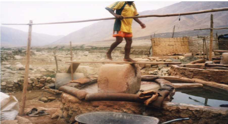
Fotografía N°A2: Molino artesanal de granodiorita para el tratamiento del oro(Quimbaletes).
