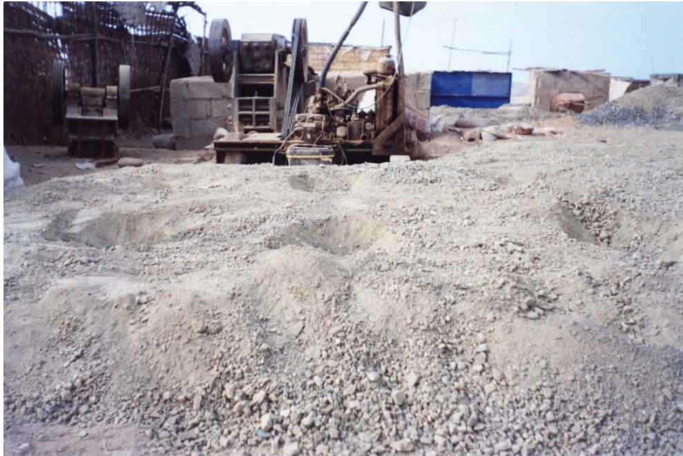
FOTOGRAFIA #A5(CANCHA DE ALMACENAMIENTO PARA LIXIVIACION ARTESANAL DE ORO)
