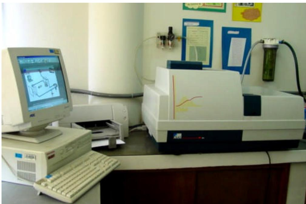
**Figura N° 25.** Granulómetro - CILAS 1064. (Fuente: [www.cilas.com](http://www.cilas.com)).
