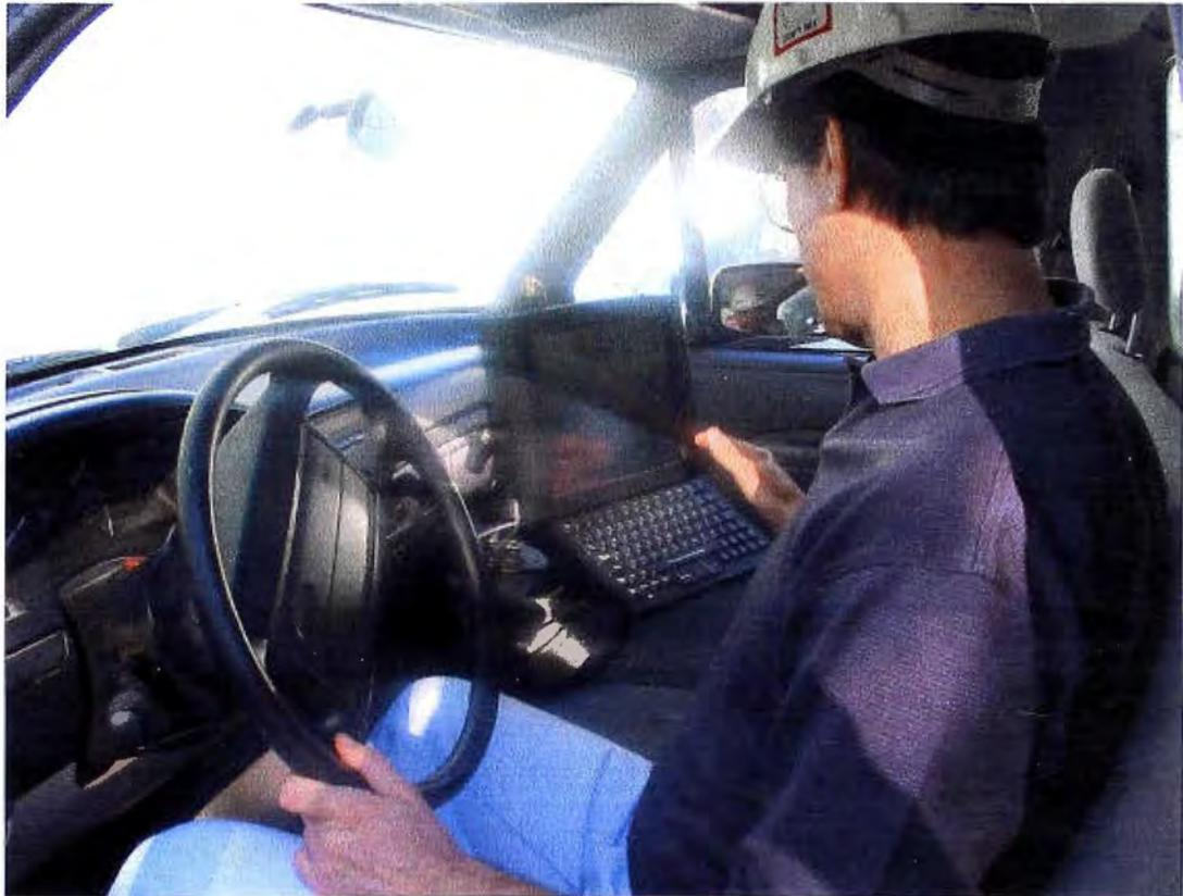
El sistema consta de un computador portátil especialmente diseñado para soportar las duras condiciones de la operación, instalado en la camioneta de cada uno de los supervisores, el cual esta conectado en forma inalámbrica al sistema.
