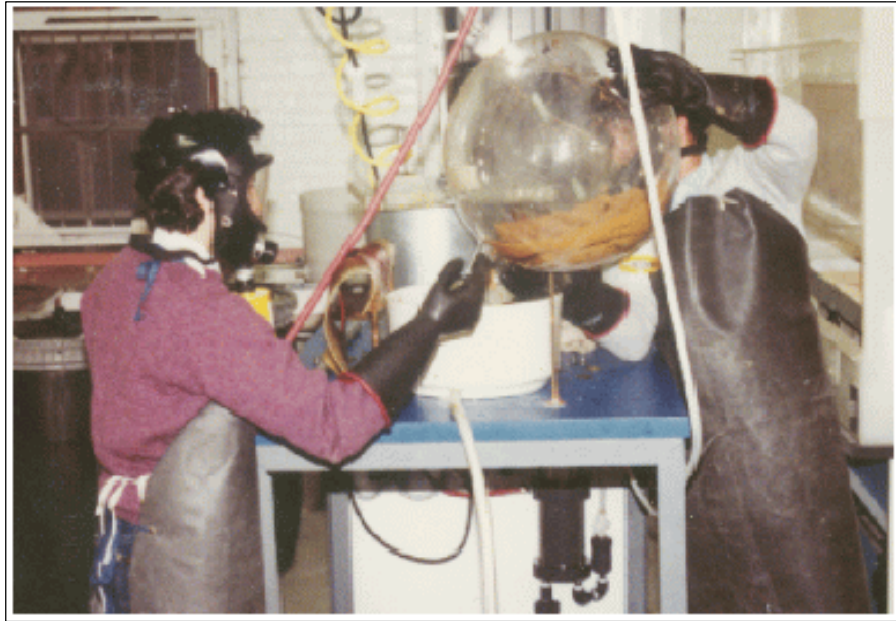
Foto 10.- Sedimentación y decantación del cemento de oro
