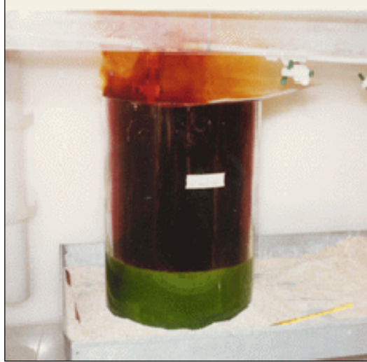
Foto 8.- Emanación de gases Nitrosos
