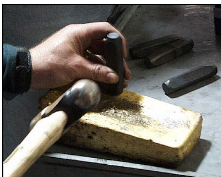
Foto N° 16. Marcado de las barras ya fundidas
