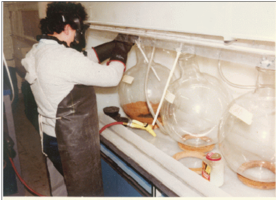
Foto 11.- Instalación de los recipientes para la purificación final
