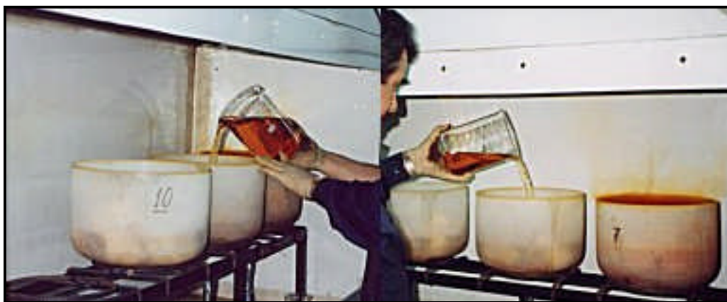
Foto 20. Realizando los ataques para la disolución de las impurezas
