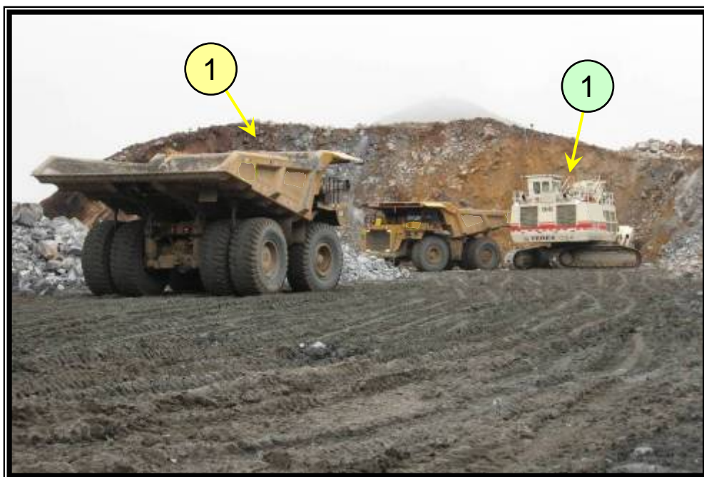
Foto 1.1.1e 01 punto de carga y una cola de 01 camión en espera. Los camiones que se muestran en la foto son de 150 toneladas, el costo de cada uno de ellos es de 2.0 millones de dólares y la excavadora de 300 toneladas cuesta 3.5 millones de dólares por lo que no se comprende como se acepta que equipos como éstos tengan tiempos de espera originados por una mala supervisión.
