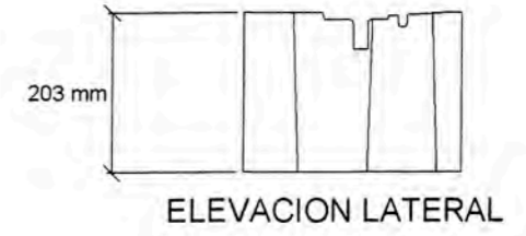
BLOQUE DE CONCRETO ESTANDAR ESC. 1/10
