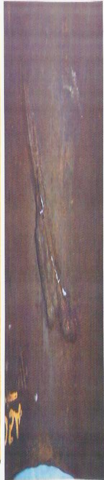
REVESTIMIENTO RECUPERADO MOSTRANDO LA RAJADURA DEL REVESTIMIENTO
