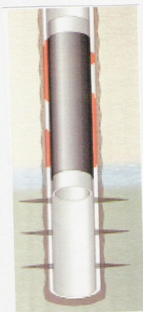
REPARACION DE FORRO CORROIDO
