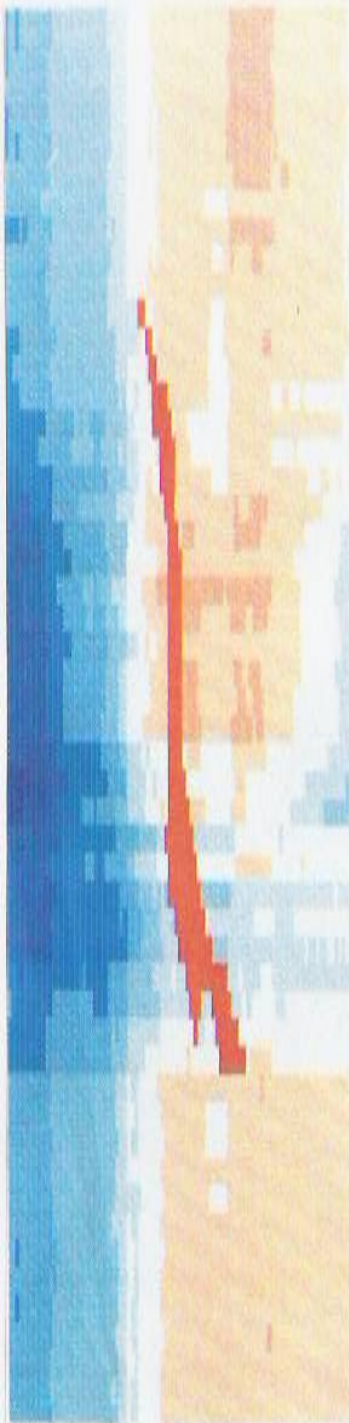
IMAGEN DE AMPLITUD DEL RADIO INTERNO INDICA UN HUECO LONGITUDINAL
