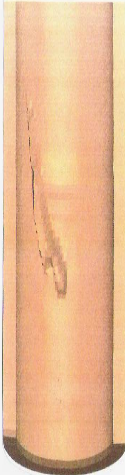
IMAGEN TRIDIMENSIONAL MUESTRA UNA RAJADURA
