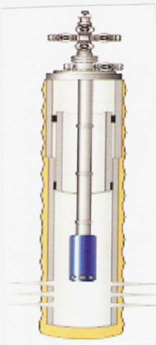
REPARACION DE FORRO PARTIDO
