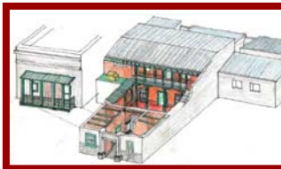
Esquemas de distribución en planta y volumetría de la casona Descalzi. Obsérvese la organización alrededor de dos patios rectangulares con corredores-galería. La conexión entre los patios es a través del corredor que se encuentra al lado derecho. Gráficos elaborados por los autores.
