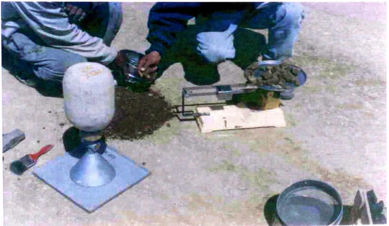
Fotografías X-1, X-2.- Secuencia del control de la “Densidad de Campo”.
