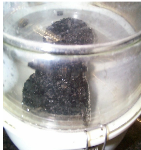
Figura 5.16: Aplicación de presión para Saturación y Congelamiento
