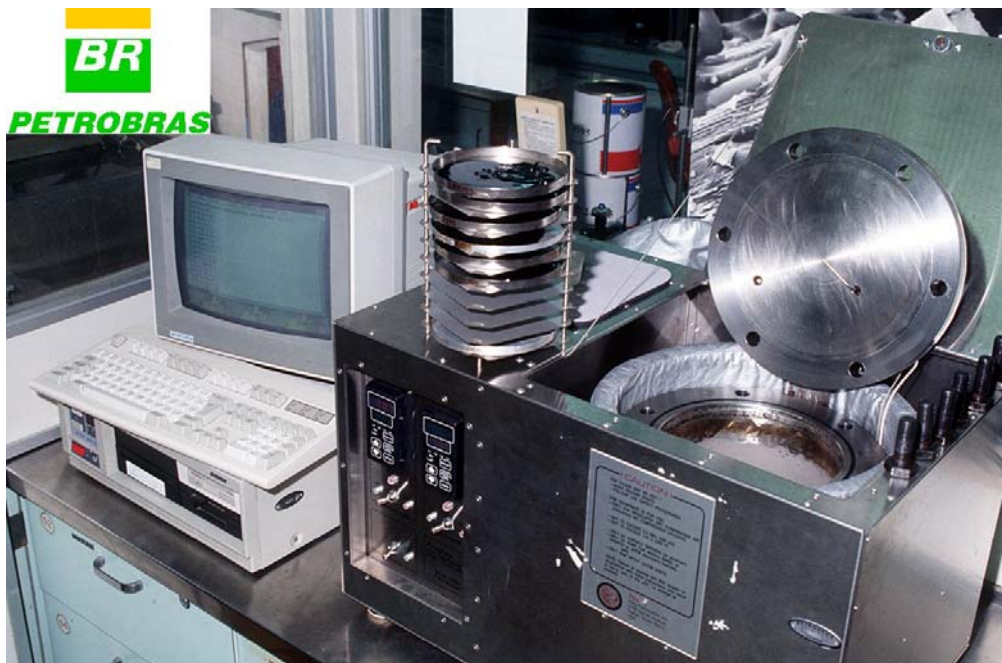
Figura 4.24 (a): Vaso de Envejecimiento PAV y equipos utilizados
