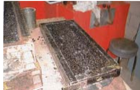
Figura 5.9(b): Placa de mezcla asfáltica compactada
