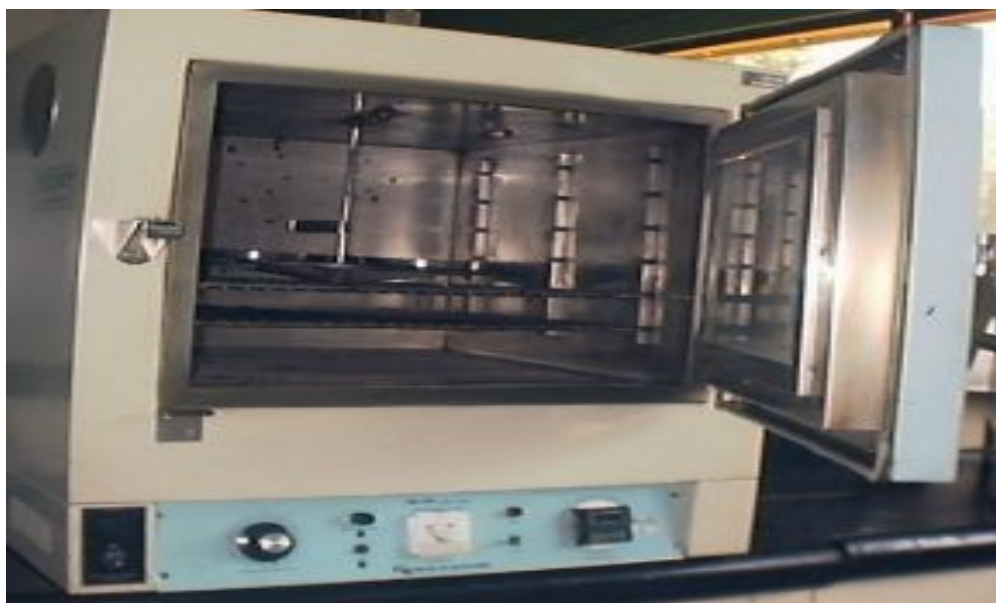
Figura 4.25 (a): Estufa de Película Delgada Plana (TFOT) Fuente: TA INSTRUMENTS 2010 (Provedora de Equipos SUPERPAVE). Dr. Abel Gaspar. EEUU (Ref. Bib.22)
