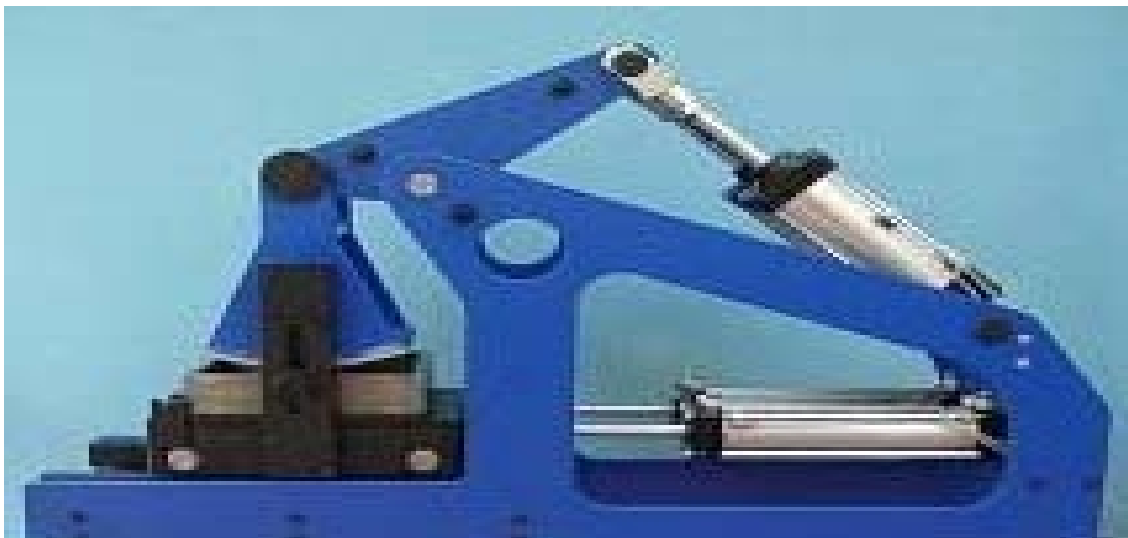
Figura 5.29: Equipo de compactación por amasado de YPF
