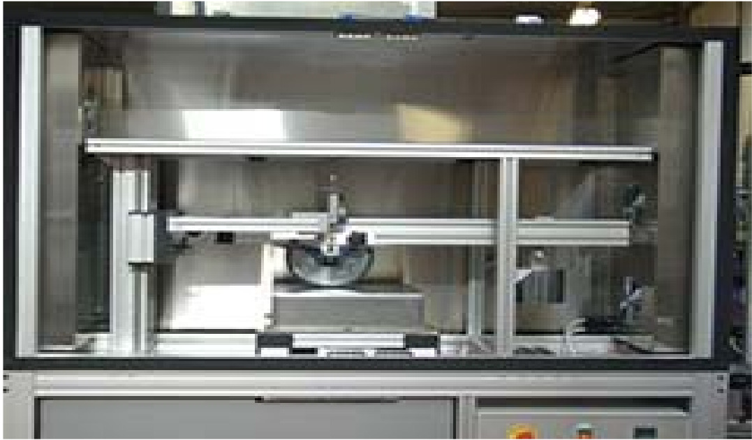
Figura 5.28: Ensayo de Rueda cargada de YPF
