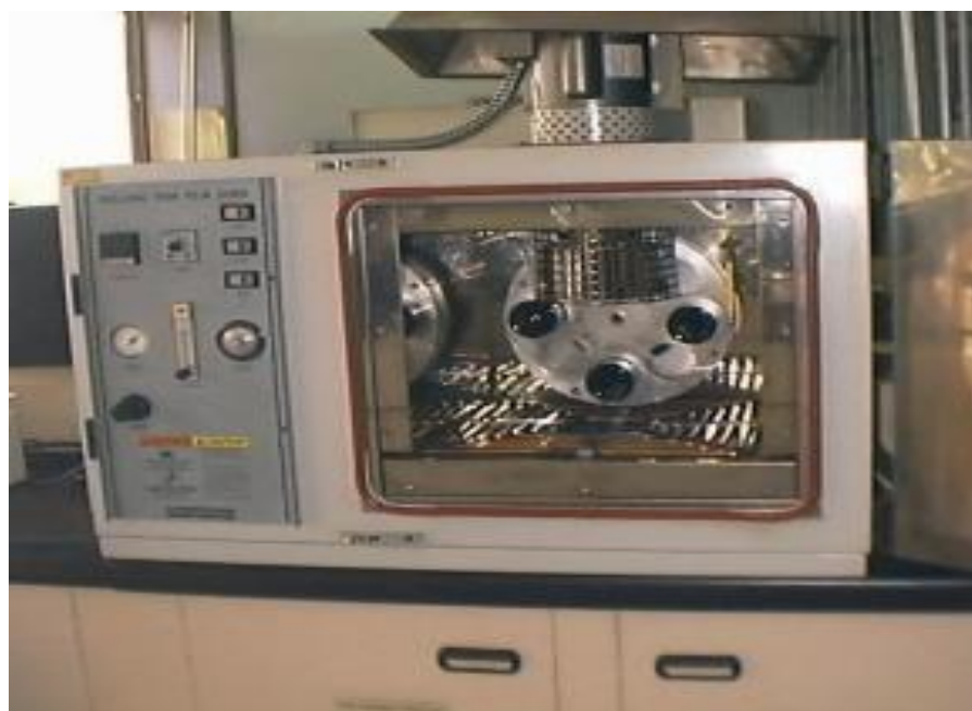
Figura 4.25 (b): Estufa de Película Delgada Rotacional (RTFOT). Fuente: TA INSTRUMENTS 2010 (Provedora de Equipos SUPERPAVE). Dr. Abel Gaspar. EEUU (Ref. Bib.22)
