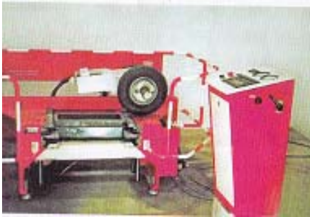
Figura 5.9(a): Mesa Compactadora LPC placas de mezclas asfálticas
