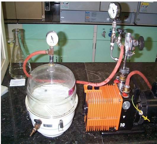
Figura 5.16: Aplicación de presión para Saturación y Congelamiento
