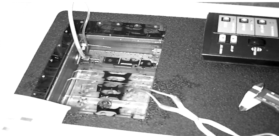
Figura 4.26: Ensayo de Tracción Directa - DTT
