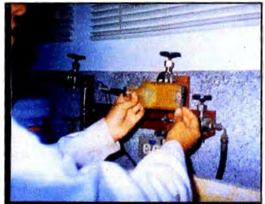
FOTO 23. MÉTODO DE INCLINACIÓN EN LA MEDICIÓN DEL POUR POINT
