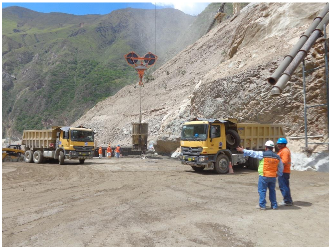
Figura N° 20 Camión Volquete alimentado desde el Chute (Fuente: Propia)
