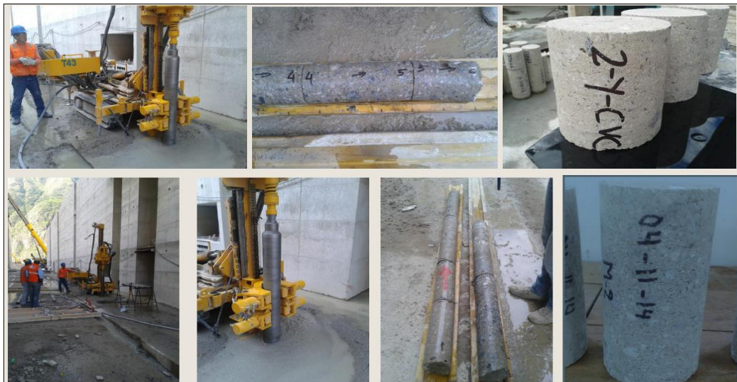
Figura N° 09 Extracción de Núcleos de CCV y CCR – Primera Campaña (Fuente: CRM)
