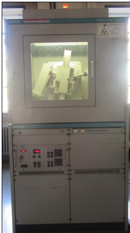
Figura 4. Difractómetro de Rayos X Siemens Krystalloflex D5000
