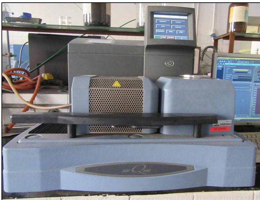
Figura 5. Equipo de análisis termogravimétrico SDT Q600.
