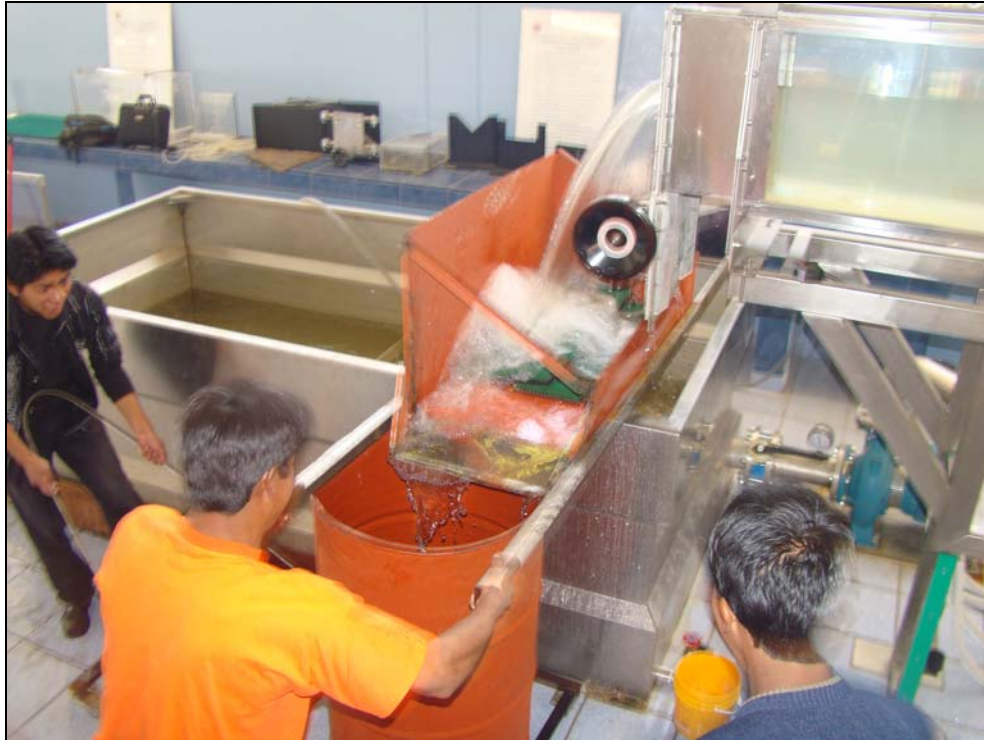
Fotografía 7.- Aforo Volumétrico con canaleta de desviación.
