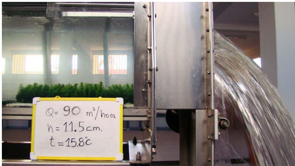
Fotografía 17.- Ensayo simulando presencia de vegetales
