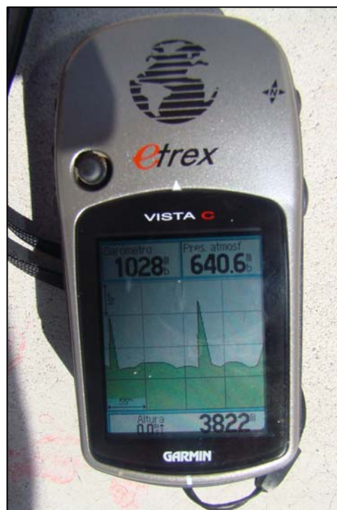
Fotografía 15.- Lectura de temperatura con termómetro de mercurio y de Presión Atmosférica con GPS.
