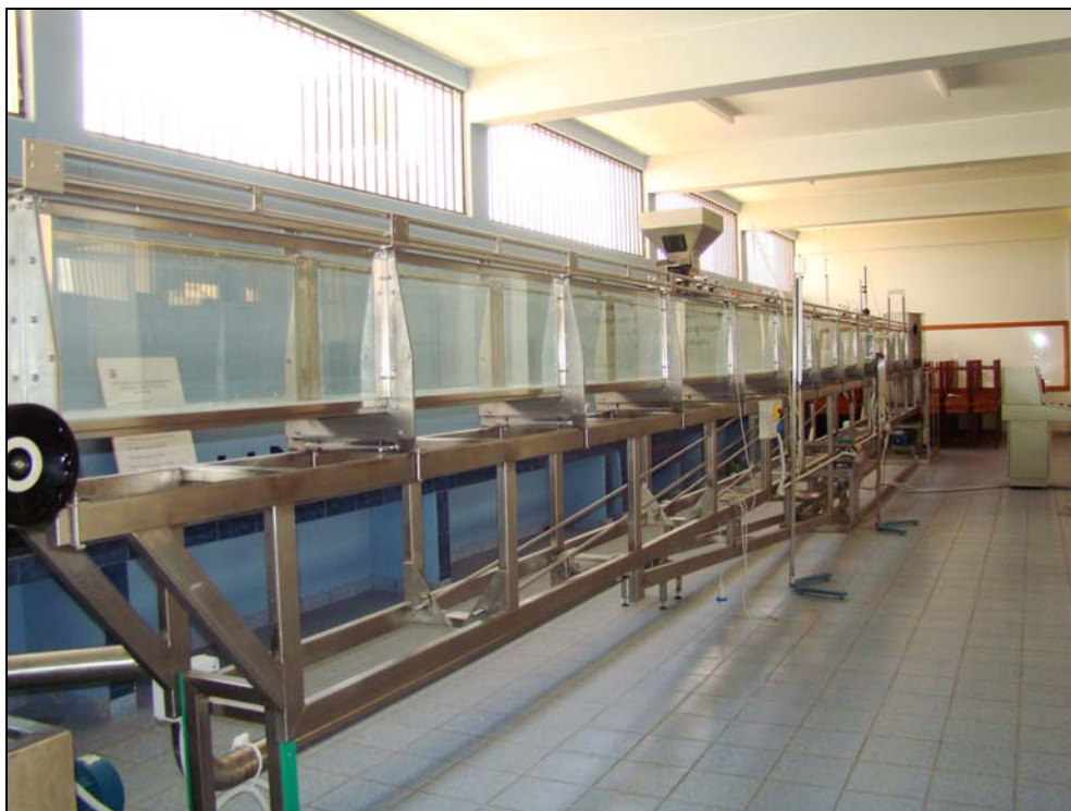
Fotografía 2.- Canal de pendiente variable de la UANCV
