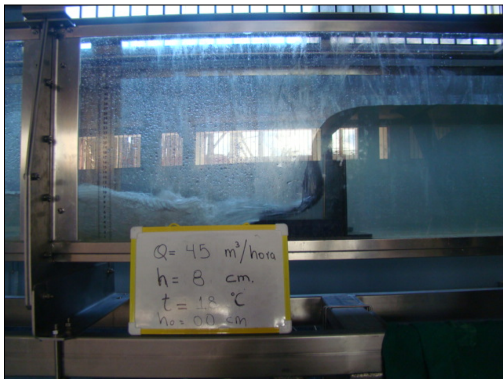
Fotografía 6.- Flujo en vertedero con napa Adherente
