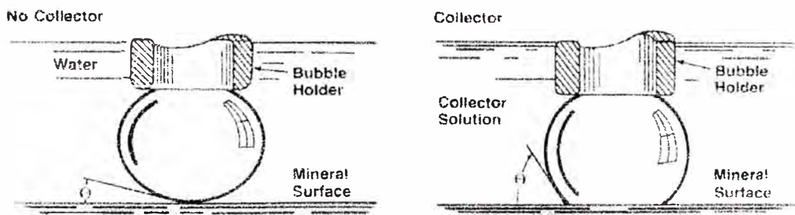
Fig. 44.- Acción del colector sobre la superficie mineral
