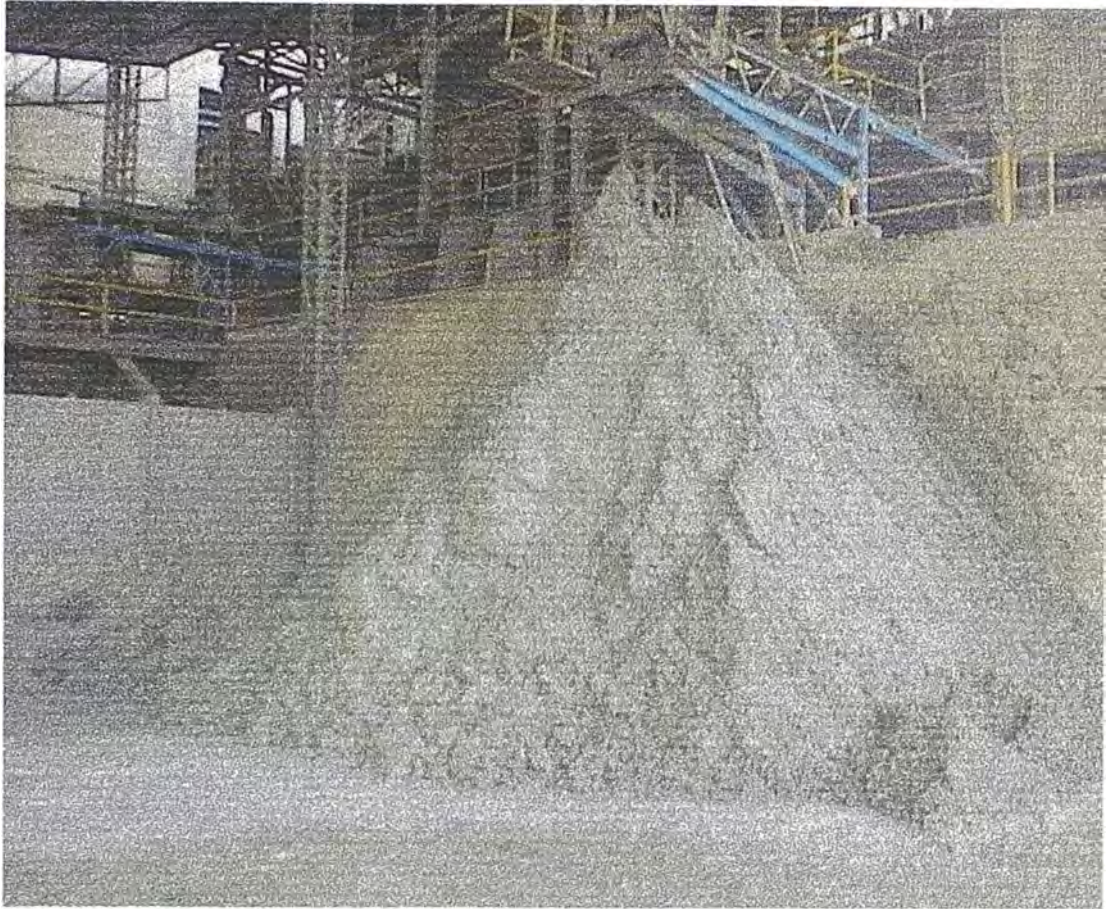
Fig. 9.- Stock pile de concentrado de zinc
