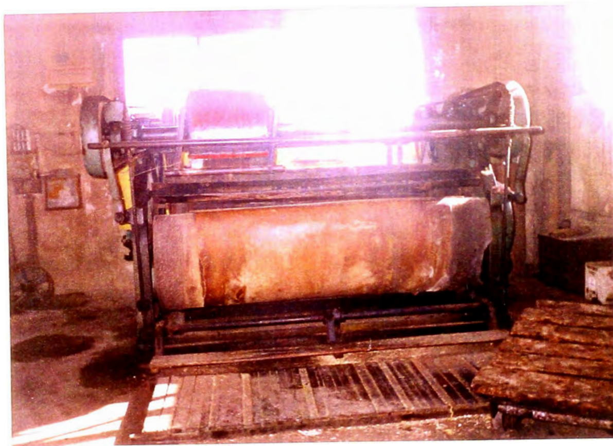
Fig. 12 MAQUINA DE CARPETEAR SUELAS
