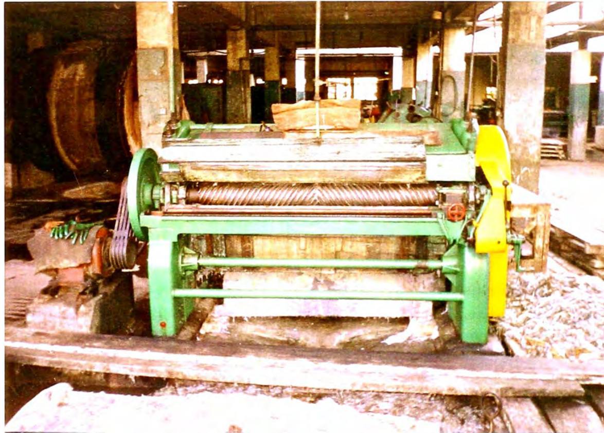
Fig. 7 MAQUINA DE DESCARNAR
