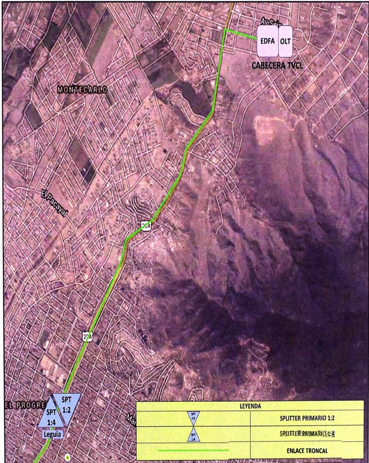
Figura 3.39 Sección alimentadora de la red piloto
