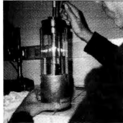
Foto 2 Equipo conteniendo acetona en el cilindro exterior y en el cilindro interior la placa de acero recubierta con asfalto
