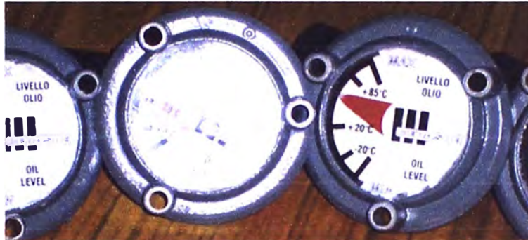
Figura 2.9 Indicador IML80 (Fuente: www.cedaspe.com )
