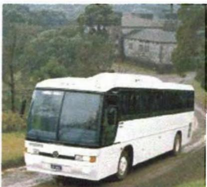
Volvo B7R, un ómnibus perfecto para su flota. Está equipado con freno motor de serie y con opcionales ABS y freno auxiliar electromagnético
