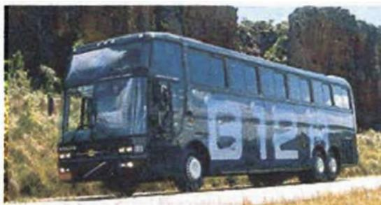
Suspensión totalmente neumática (trasera independiente en la versión 6x2), con válvulas de control de nivel y sistema para alivio del 3° eje (6x2). Disponible para aplicaciones en largas distancias y turismo con carrocerías de hasta 14 m de longitud total, inclusive en las versiones "Low Driver" y "Double Deck".
