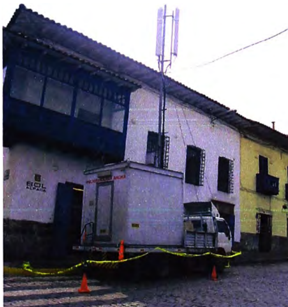
Fig. 2.9. Implementación de Estación Móvil (Truck)
