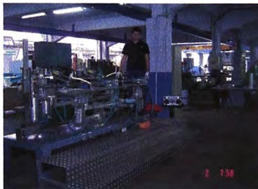
(c) Máquina Hidráulica para formación de bobinas
