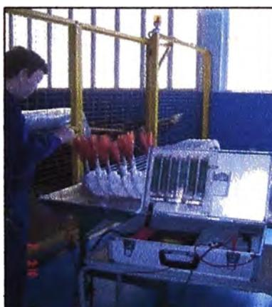
Fig. 5.4 Prueba de aislamiento entre conductores
