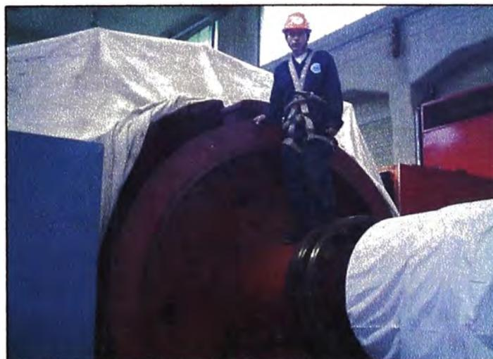
Fig. 5.25 Tratamiento térmico-encerramiento del estator
