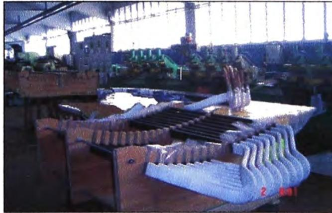
(a) Modelo a escala del núcleo estático
