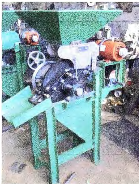
Figura 1.3 Despulpadora de café, trifásica: 500 kg/hora (Fuente: Ref: [9])
