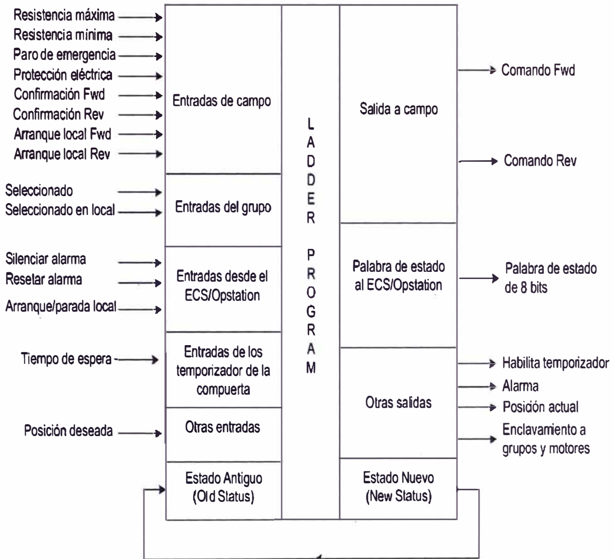
Figura 2.11 Descripción Sub-rutina Compuerta (Fuente: Referencia [12])
