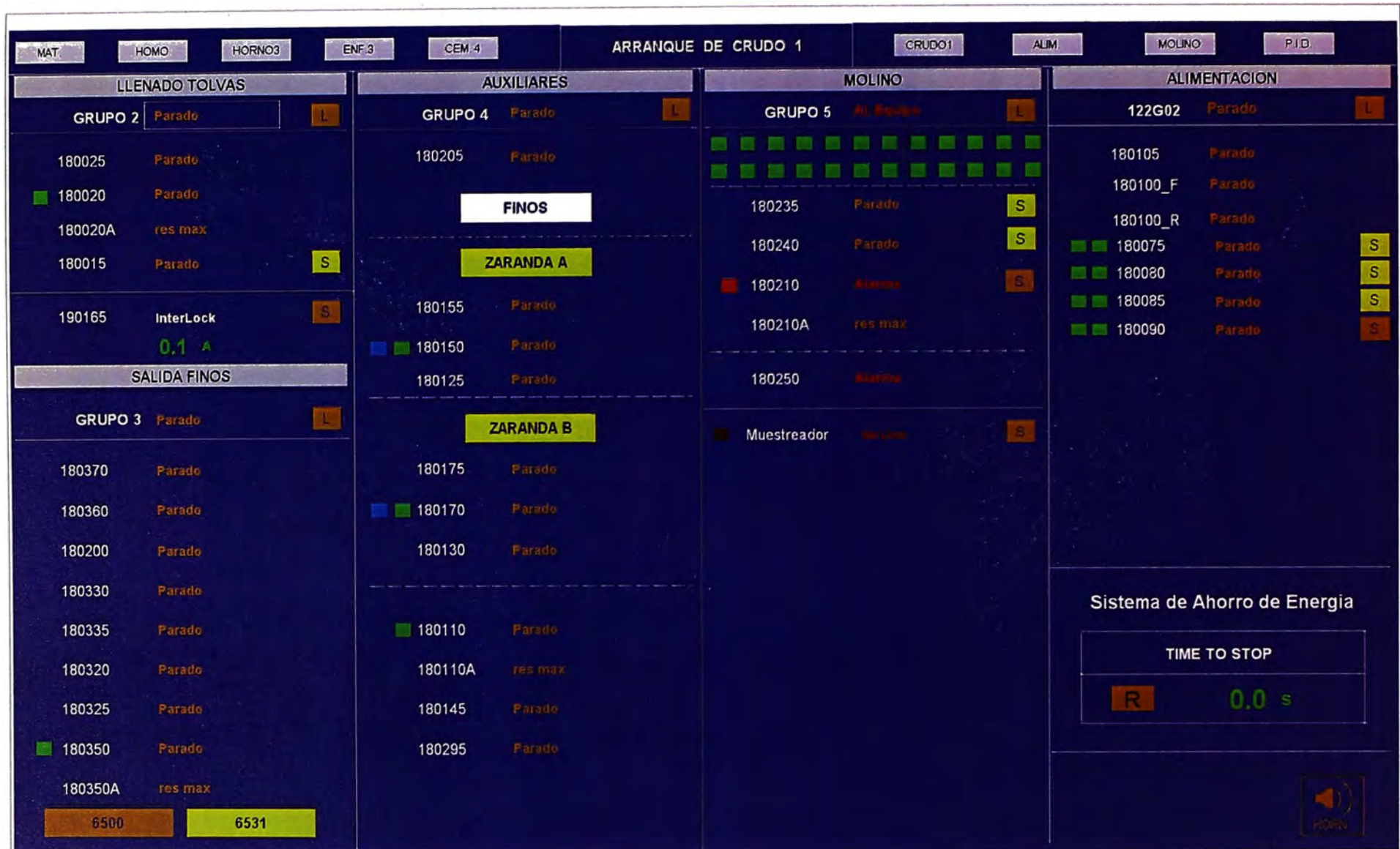
Figura 2.28 Pantalla de arranque Molino Crudo 1 (Fuente: SCADA CPSAA)
