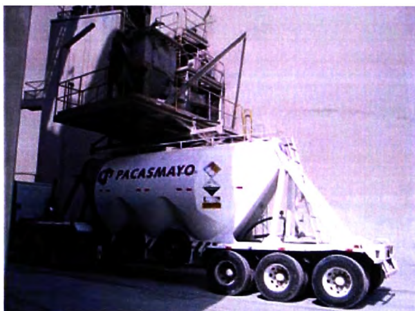
Figura 1.30 Despacho a granel (Fuente: Cementos Pacasmayo)
