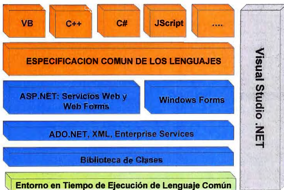
Figura 2.13 Elementos de la plataforma .NET (Fuente: Ref. [5])
