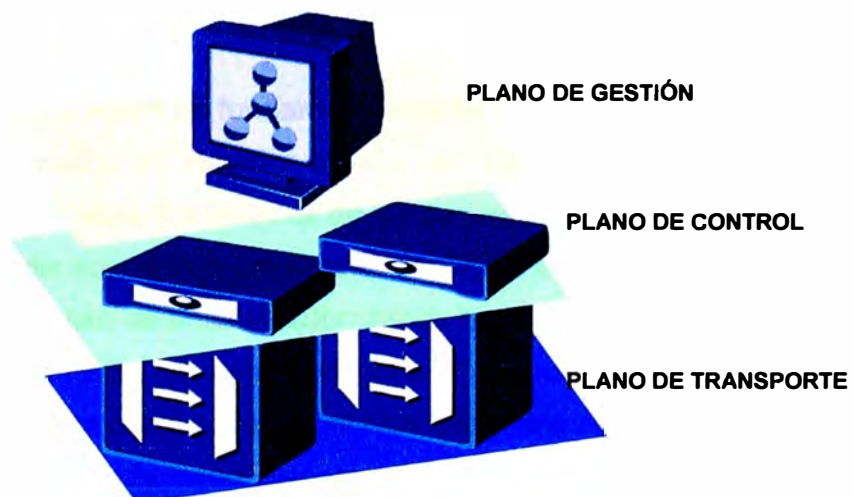
Figura 2.1: Arquitectura de la red óptica conmutada automática
