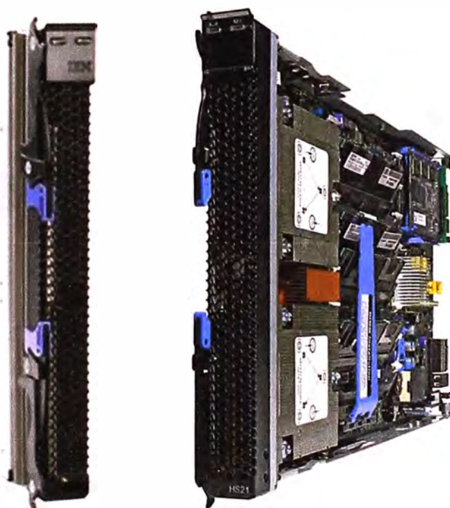
Figura C.2 Servidor Blade IBM BladeCenter HS21 XM (Fuente: Ibídem)
