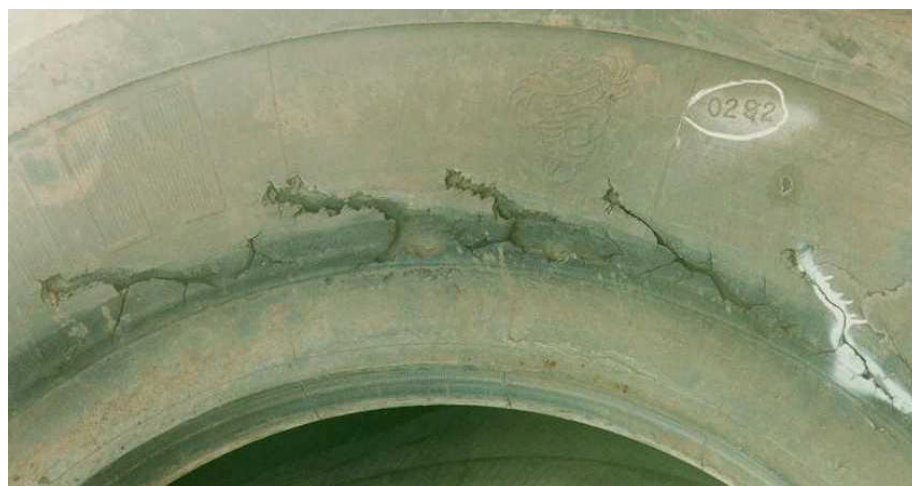
Foto 1.9: Daños en el talón del neumático
