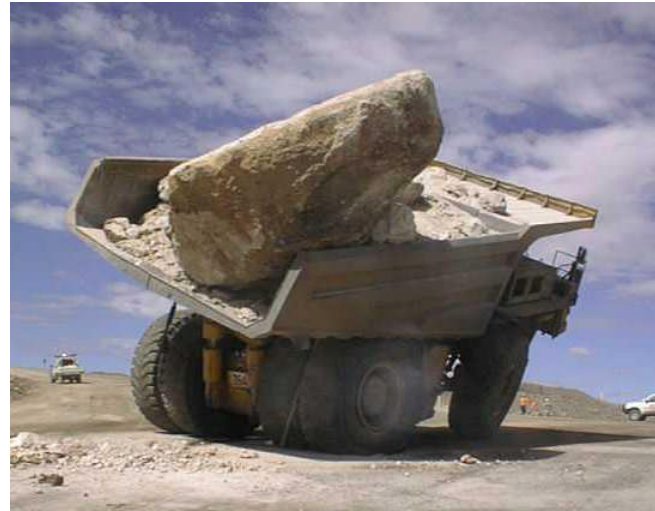
Foto 1.5: Rocas demasiado grandes en el volquete
