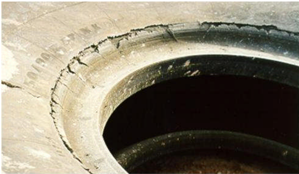
Foto 1.10: Daños en el talón por el Tamaño del flange
