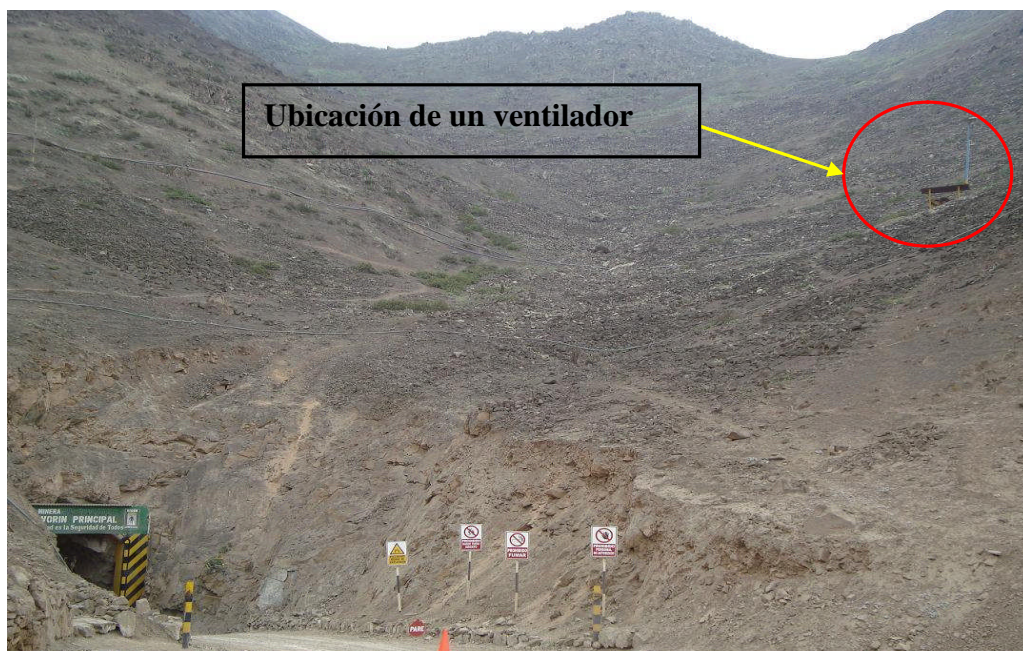
Figura 1.2. Ubicación inicial de un ventilador de baja potencia en la mina subterránea.
