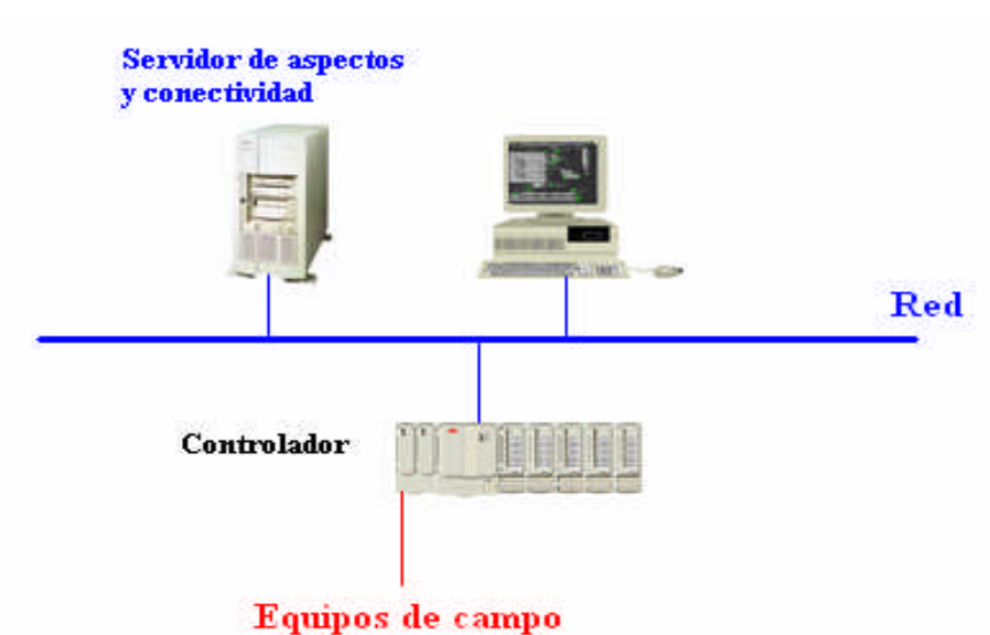
Figura 5.1. Red de control y cliente/servidor combinadas
